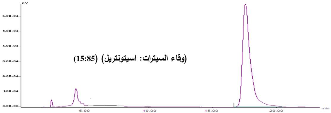
الشكل (12): كروماتوغرامات الأرجينين العياري عند استخدام نسب مختلفة من الطور المتحرك: (اسيتونتريل: وقاء السيترات) باستخدام تقنية HPLC (كاشف الفلورة، معدّل التدفق 1 مل/د، حجم الحقنة 20 ميكرو لتر)
