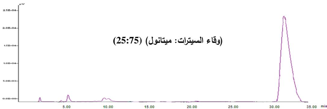
الشكل (13): مقارنة كروماتوغرامات الأرجينين العياري عند تغيير طبيعة الطور العضوي في الطور المتحرك باستخدام تقنية HPLC (كاشف الفلورة، معدّل التدفق 1 مل/د، حجم الحقنة 20 ميكرو لتر)
